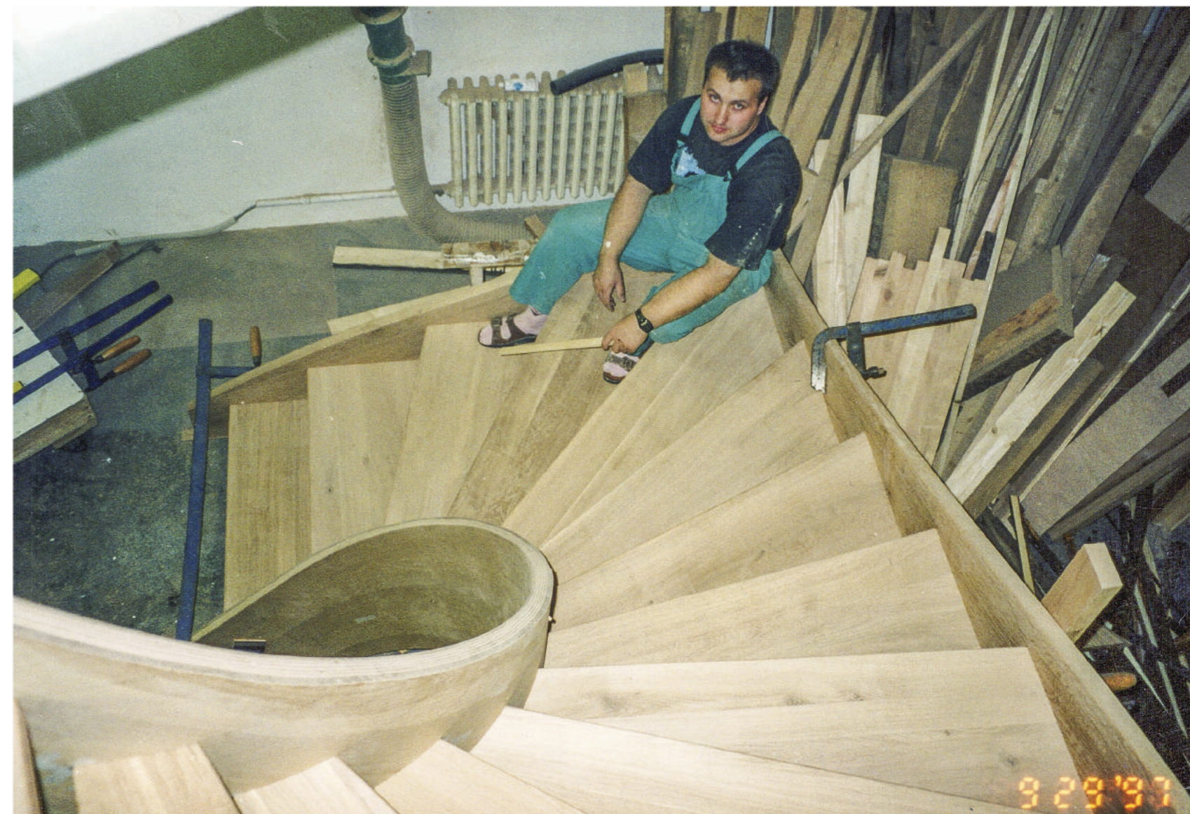
Výroba schodů v truhlárně ul. Nerudova, Benešov.
